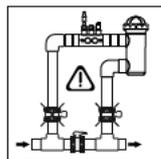
**ATENCIÓN:** el detector de flujo (detector gas) no funcionará correctamente, con el consiguiente riesgo de ruptura de la célula, si se cierran simultáneamente las válvulas de entrada y salida a la tubería donde va instalada la célula de electrolisis. Aunque resulta una situación inusual, se puede evitar bloqueando, una vez instalado el equipo, la válvula de retorno hacia la piscina, de forma que no pueda ser manipulada accidentalmente.
