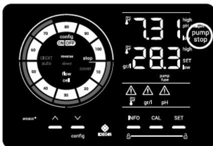
**ES** Los controladores disponen de un sistema de seguridad (FUNCIÓN PUMP-STOP) que actúa sobre la salida de control permitiendo evitar las siguientes situaciones:
