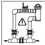
**ACHTUNG:** wenn beide Ventile, Eingangs- und Ausgangsventil zur Rohrleitung, dort wo die Elektrolysezelle angeschlossen ist, gleichzeitig geschlossen werden funktioniert der Strömungs-Messer nicht richtig und kann sogar beschädigt werden. Obwohl dies eine ausgesprochen ungewöhnliche Situation darstellt, kann sie vermieden werden, indem das Rückflussventil zum Schwimmbad nach dem Einbau des Geräts verriegelt wird. Somit kann es nicht aus Versehen manipuliert werden.
