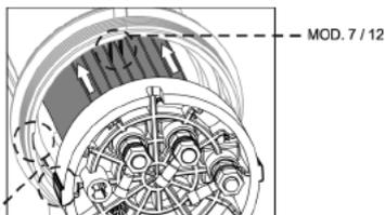
Los electrodos de los modelos deberán ser introducidos en el interior de la célula de electrolisis encajando el electrodo central del conjunto a través de las guías situadas en los cuadrantes del cuerpo de la misma.
