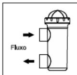
É preciso respeitar o sentido de fluxo marcado na célula. O sistema de recirculação deve garantir o fluxo mínimo indicado na Tabela de Especificações Técnicas.
