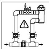
**ATTENZIONE:** il rivelatore di flusso non funzionerà correttamente, con il conseguente rischio di rottura della cellula, se si chiudono simultaneamente le valvole di entrata ed uscita alla tubazione dove deve essere installata la cellula elettrolitica. Nonostante sia una situazione inusuale, può essere evitata bloccando, una volta installato l'impianto, la valvola di ritorno verso la piscina, in modo che non possa essere manipolata accidentalmente.
