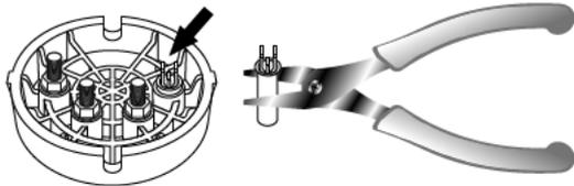
**FR** La cellule doit se maintenir dans des conditions adéquates pour assurer une longue durée de fonctionnement. Le système d'électrolyse saline dispose d'un système de nettoyage automatique des électrodes qui évite la formation d'incrustations calcaires et c'est pourquoi, en principe, il ne sera pas nécessaire les nettoyer. Cependant, si le nettoyage à l'intérieur de la cellule est nécessaire, procédez de la manière suivante :
