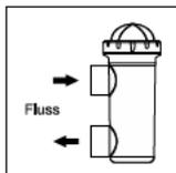
Die in der Zelle angegebene Strömungsrichtung muss unbedingt beachtet werden. Die in der Tabelle „TECHNISCHE ANGABEN“ angegebene Mindestdurchflussmengen für die verschiedenen Modelle, müssen vom Umlaufsystem eingehalten werden.
